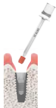
가이드가 체결된 상태로 Screw Remove Tip을 삽입하여 Screw를 Pick Up 후 제거
