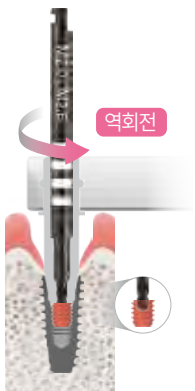
Reverse Cutting Drill을 사용하여 역회전 (1mm 이상 홀생성)
